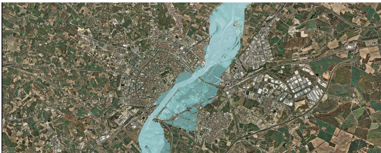
Inundabilitat per a períodes de retorn de 10, 50, 100 i 500 anys per al riu Segre al seu pas per Lleida. Font: Ministerio de Medio Ambiente
