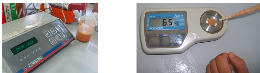
Figura 40. Material utilizado para la determinación de la calidad de los frutos. De izquierda a derecha, pH-metro y refractómetro utilizados en la medición del pH y sólidos solubles del licuado respectivamente.
