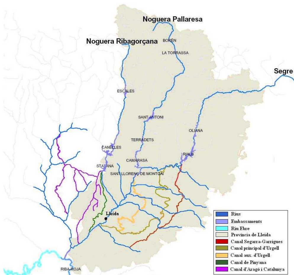
Figura 1.6. Canals de regadiu de la conca del riu Segre. A la figura s'indiquen també els embassaments.
